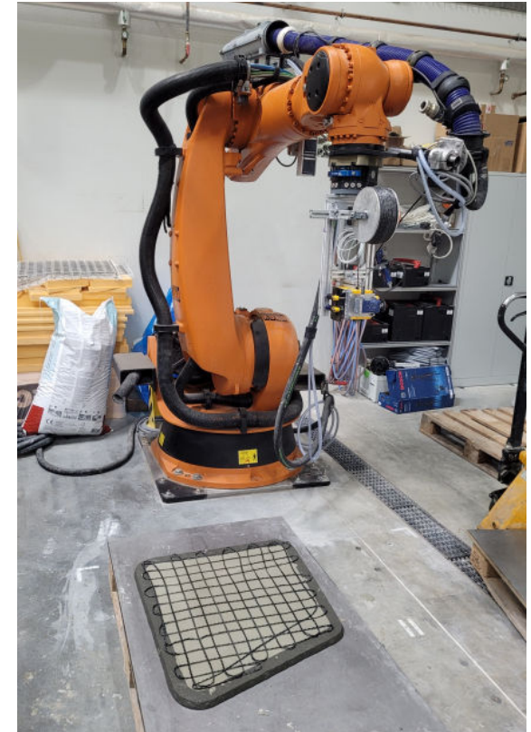
Robotische Verlegung von Carbongarn
